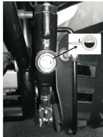
Vérifiez le niveau du liquide de frein dans le bocal situé sur le dessus de la pédale de frein. Le niveau de liquide ne doit jamais descendre en dessous de la limite «L».
